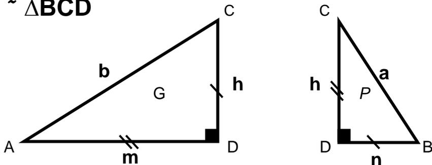
$$\frac{P}{G} : \begin{array}{c} / \quad // \\ \frac{n}{h} = \frac{h}{m} \end{array}$$
