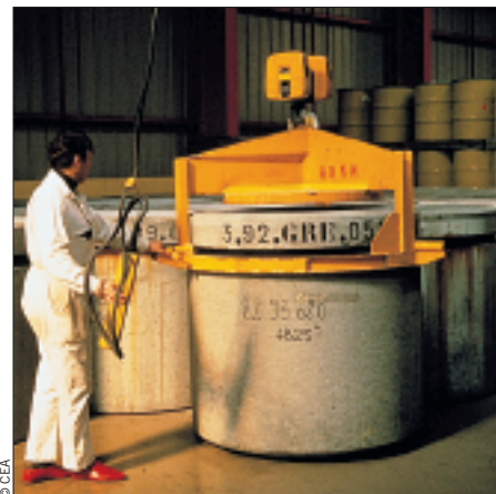
Conditionnement des déchets dans une matrice en béton.
