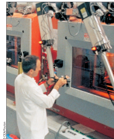
Chaîne blindée de vitrification des produits de fission.
